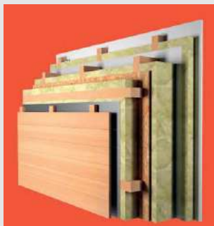
Vanjski zid Horizontalna drvena fasada
