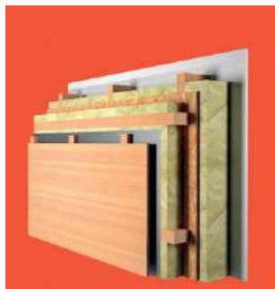
Vanjski zid Horizontalna drvena fasada
